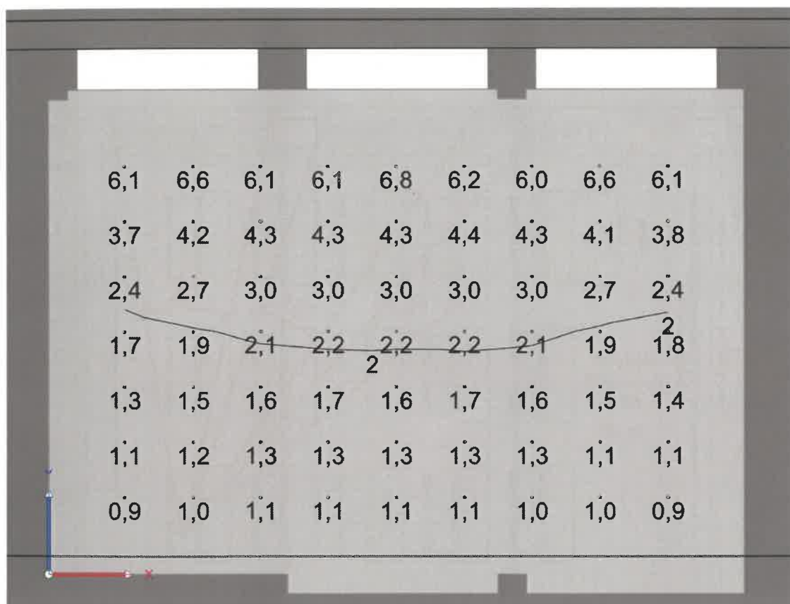
Obr. 3 – Půdorys učebny s činiteli denní osvětlenosti
